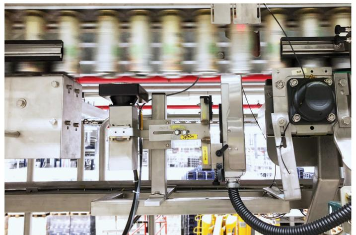
Ein Vakuumband saugt die leeren Dosen am oberen Dosenrand an, so dass die Dosen von unten kodiert werden können
