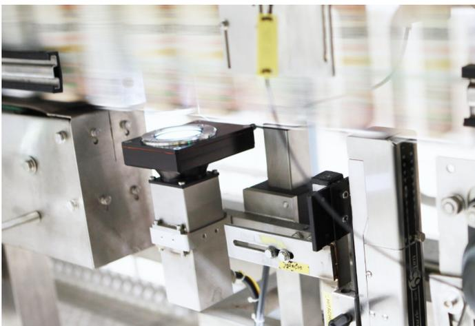
Ein Kamerasystem prüft und verifiziert die Kodierung
