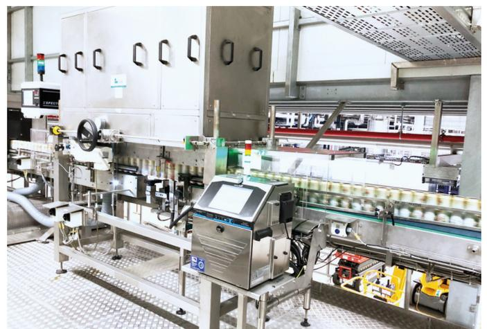
Der TwinNozzle-Drucker verfügt über zwei Düsen je Druckkopf und kodiert bis zu 45.000 Dosen in der Stunde
