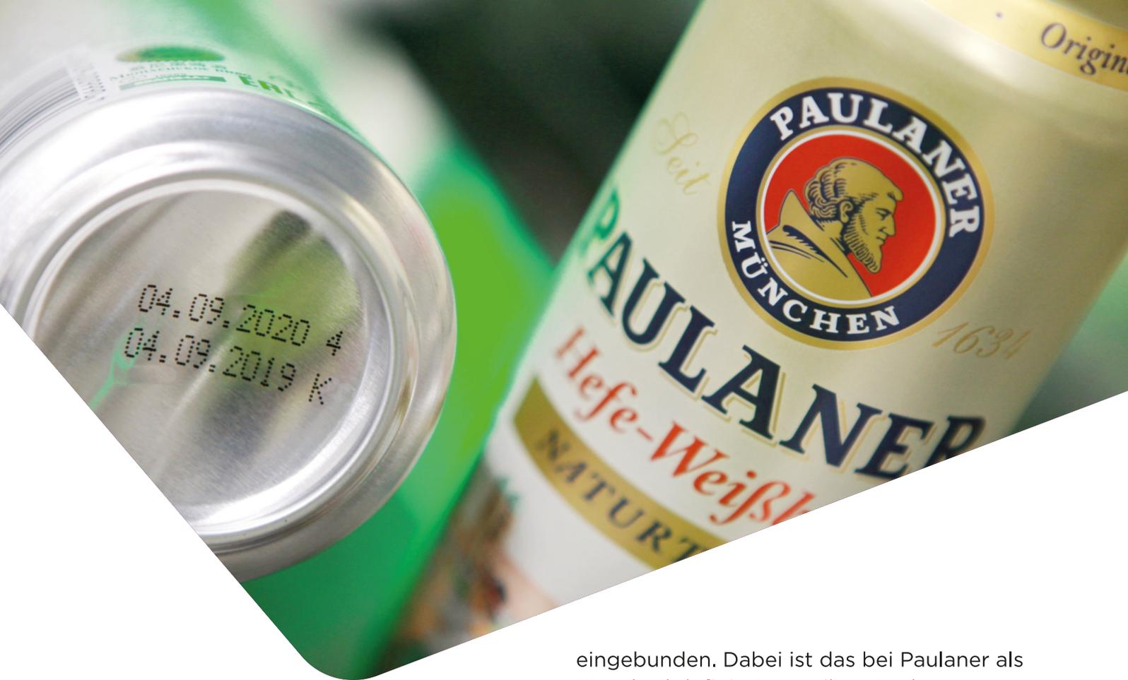
Ein besonderes Augenmerk galt der Auswahl der Tinte. Mit dem Tintentyp 1119K kommt eine besonders tiefschwarze Tinte zum Einsatz, welche auf dem Dosenmaterial sehr gut haftet. Diese Tinte und das passende Solvent sind in praktischen UX-Systemflaschen abgefüllt. So können die Bediener unterbrechungsfrei und sauber die Betriebsmittel nachfüllen.
